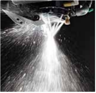
气压助推式刀具冲洗 以高喷射压力、喷射流量，强力冲掉刀柄上附着的切屑。装备过滤器堵塞警告功能。
