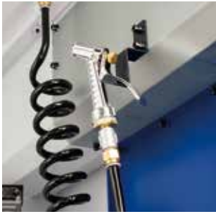
冲洗水枪 便于进行加工后的工件清扫、机内的切屑清扫。
