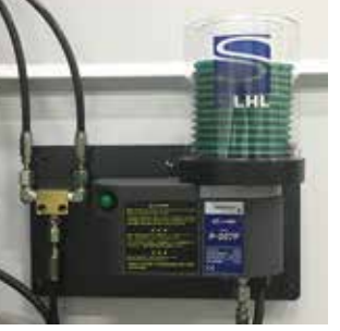
自动给脂润滑装置 3轴的给脂点全部是定期供给润滑脂。 *注意：如使用指定外的润滑脂会导致机床故障，请不要使用指定外的润滑脂。
