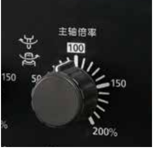
主轴倍率(标配) 无需变更程序即可变更主轴速度。
