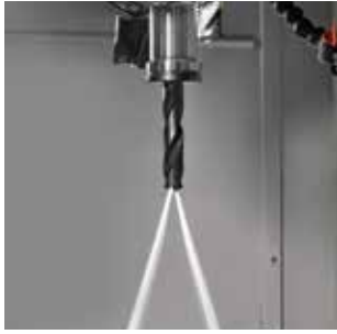
主轴中心出水(CTS) 可从耐压3.0Mpa和耐压7.0Mpa中选择。在深孔的无阶梯加工中特别有效。
