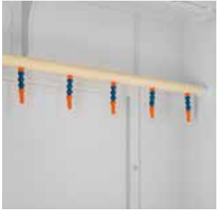
侧冲洗 将切屑冲洗配管配置在机内上部，提高排除效果，可自由对准机床罩侧面或切屑容易堆积的位置。
