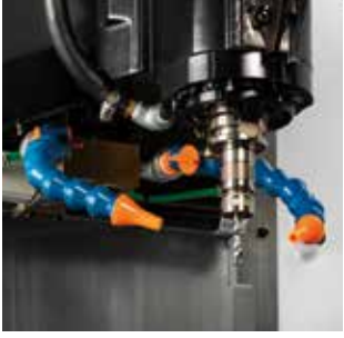
主轴头切削液喷嘴 喷嘴与刀具位置恒定，冷却液可以准确喷洒到加工部位。
