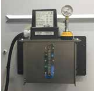
自动给油润滑装置(标配) 定期对3轴的给油点进行给油。
