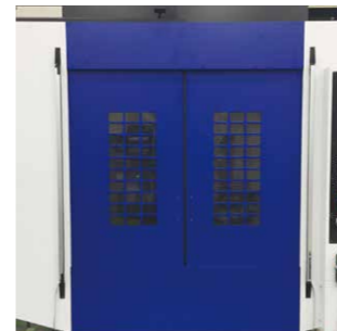
エリアセンサ 光学式のエリアセンサを採用しています。自動扉の挟まれ防止に使用します。
