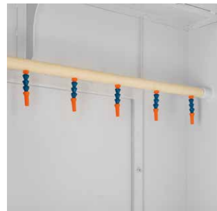
チップシャワー チップシャワー配管を機内上部に配置することで排除効果が高く、機械カバー側面や切粉のたまり易い所に自由自在に狙うことができます。
