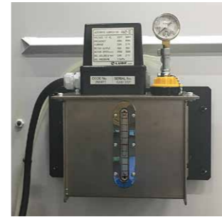
自動オイル潤滑 3軸の給油ポイントに定期的に給油します。*標準仕様は手動によるグリス給脂になります。
