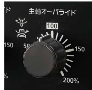
主軸オーバライド プログラムを変更せずにスピンドル速度の変更ができます。
