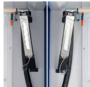
機内灯 1灯(右側、左側) LEDタイプを採用し、高寿命化と省エネを図っています。
